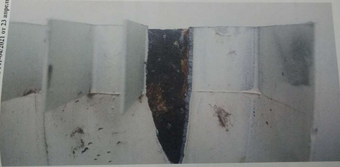
Иллюстрация № 1 Вид дефекта секции радиатора на разрезе
